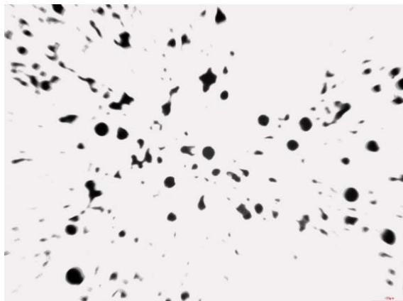
ნახ. 3. Al-Mg-იანი ლიგატურით მოდიფიცირებული თუჯის მიკროსტრუქტურა ( $\times 100$ )
